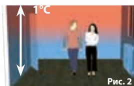
Комната с системой отопления на пониженной температуре: незначительная стратификация, улучшенный комфорт.
